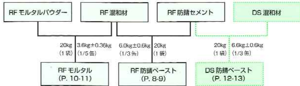
図 7.1 既調合モルタル粉体と専用混和材の組合せ（点線は応用仕様の応用材料）
